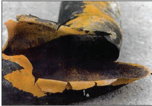
الشكل 3-11: سماكة الأنبوب مكان التسرب
