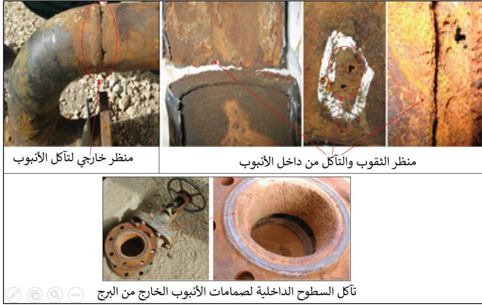
الشكل 4-27: تآكل الأنبوب الخارج من برج امتصاص كلوريد الهيدروجين
