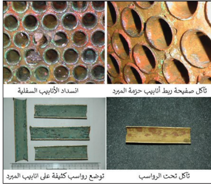
الشكل 4-50: انسداد وتآكل أنابيب المكثف
