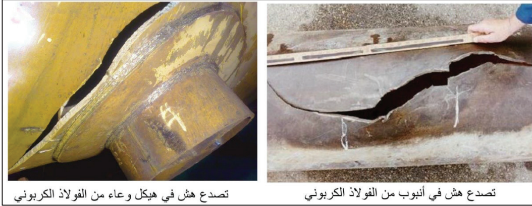
الشكل 1-35: نماذج تصدع هش أثناء اختبار الضغط بالماء
