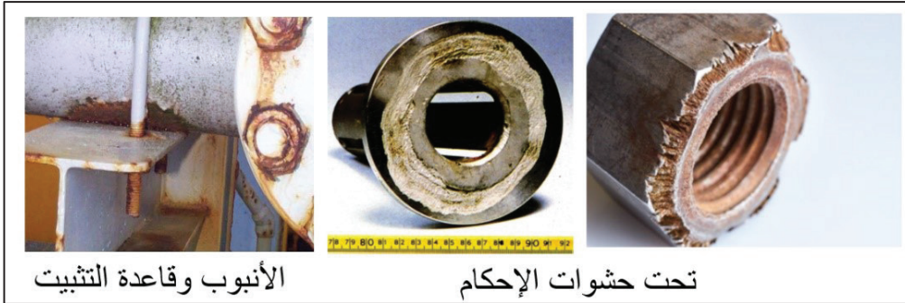
الشكل 14-1: تآكل تجويفي تحت حشوات الإحكام وبين سطح الأنبوب وقاعدة تثبيته
