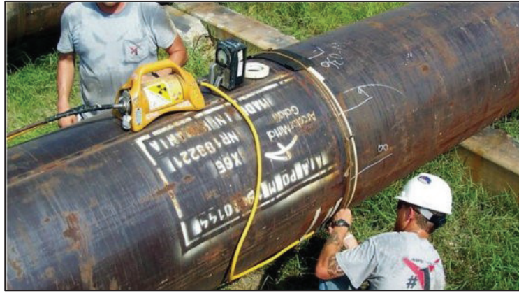
الشكل 2-22: جهاز تصوير إشعاعي لقياس سماكة الأنابيب
